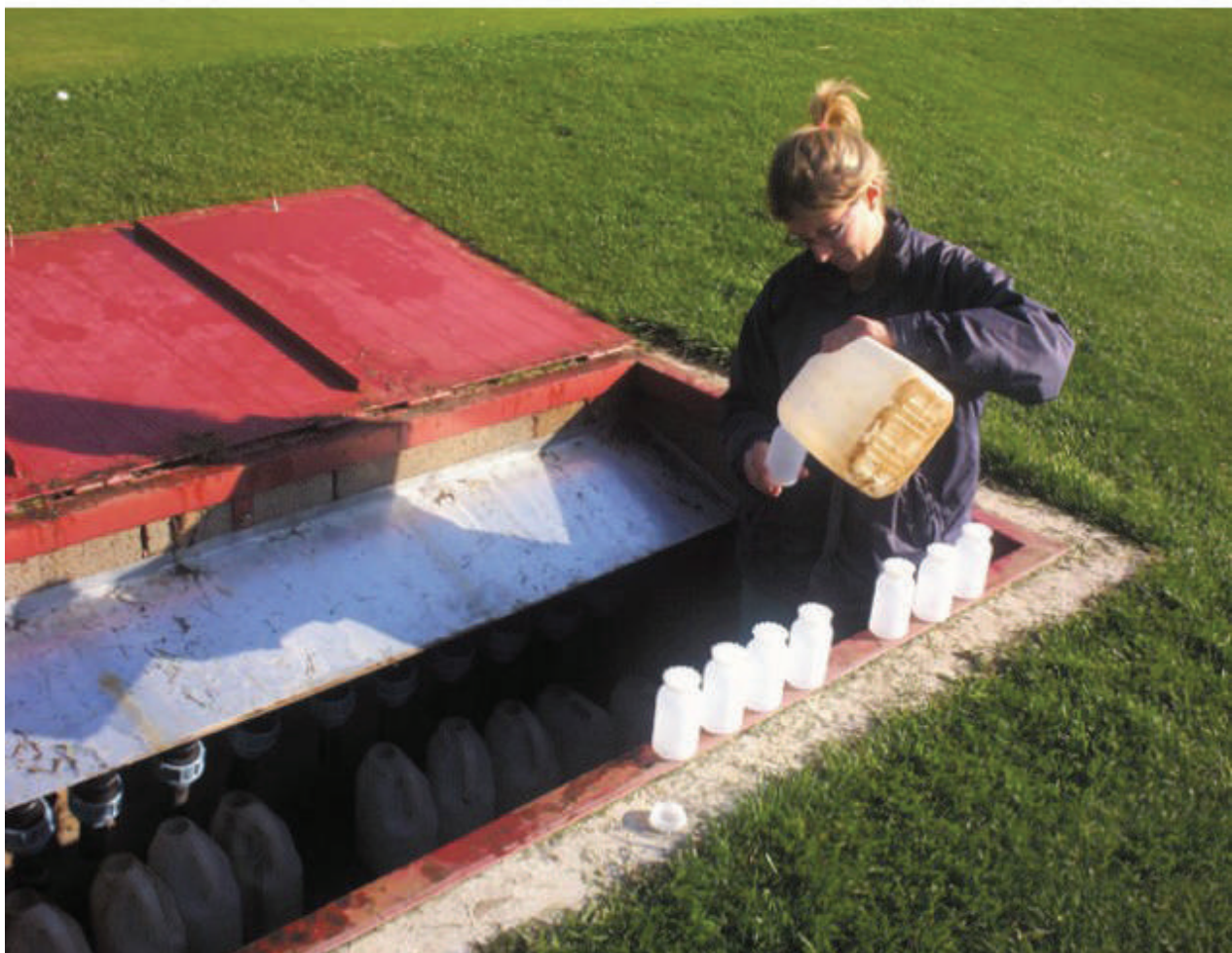
Prelievo di campioni dell'acqua di percolazione del green
