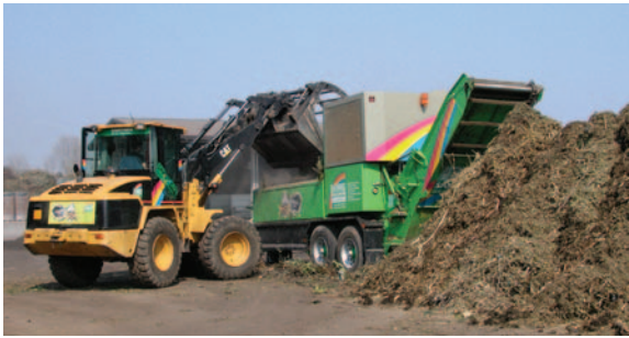
Triturazione dell'ammendante compostato verde
