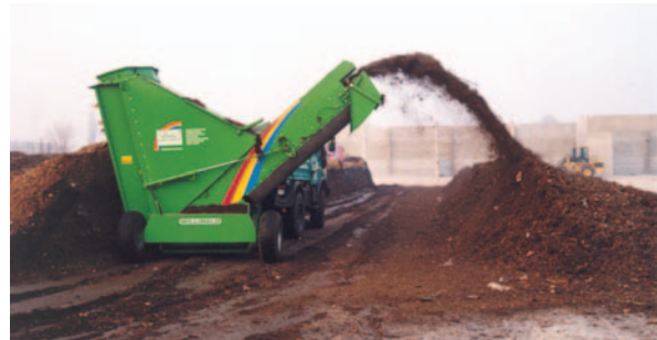
Rivoltamento dell'ammendante compostato verde
