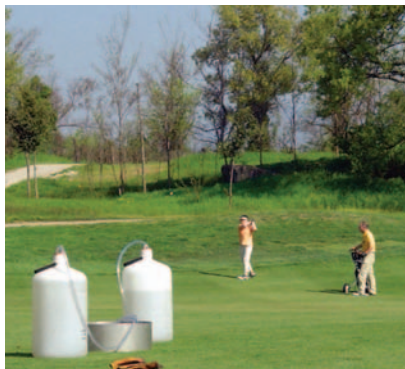
Misura della velocità di infiltrazione in campo sui fairways
