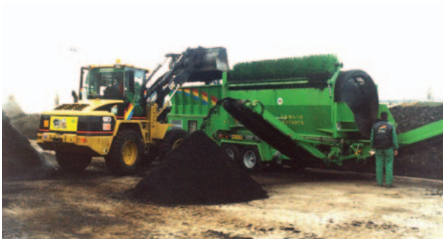
Vagliatura dell'ammendante compostato verde
