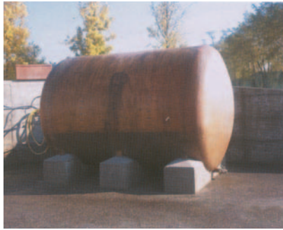
Botte per la preparazione dell'estratto di compost
