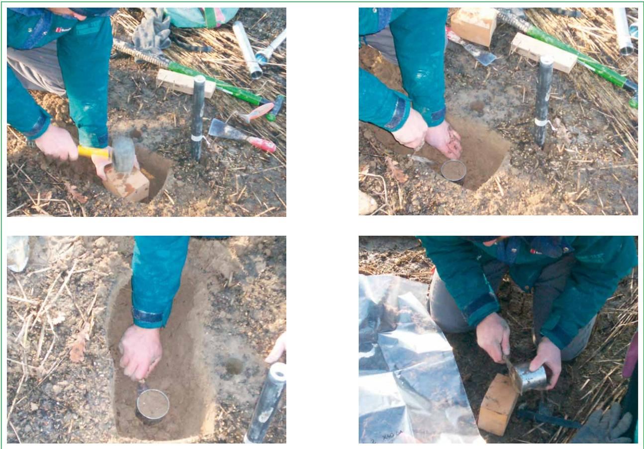
Figura 22 - Alcune fasi del prelievo del campione di densità apparente
