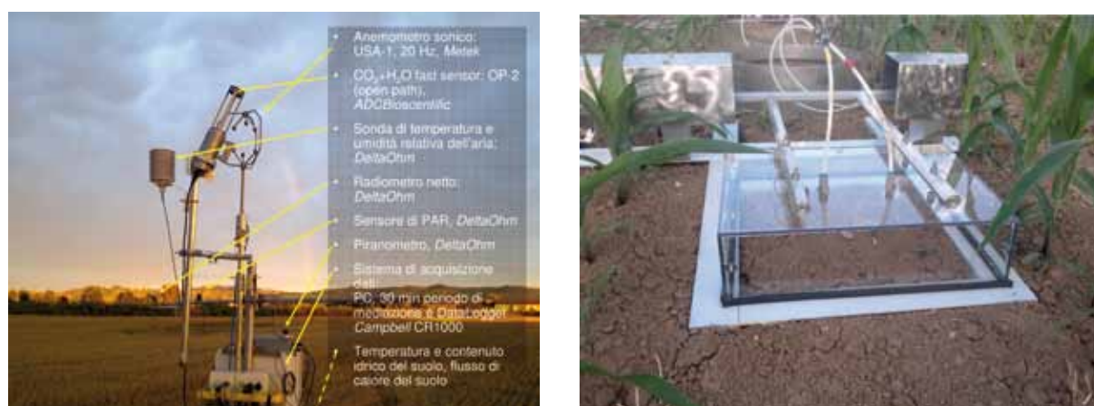
Figura 3.16 – Stazione micrometeorologica utilizzata nei campi coltivati a sodo (sinistra) e sistema di camere statiche SASSFLUX impiegato nella fase finale del progetto.
