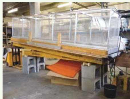
Camera della pioggia utilizzata nella sperimentazione
